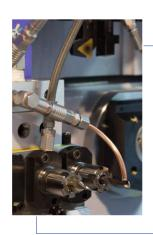
1. COMPLETE DISTRIBUTION SYSTEM WITH QUICK CONNECTIONS FOR MACHINING WITH MEDIUM AND HIGH-PRESSURE COOLANT
