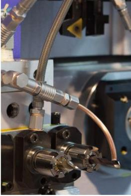
**1. SISTEMAS DE DISTRIBUCION DE REFRIGERANTE CON CONEXIÓN RAPIDA PARA EL MECANIZADO CON MEDIA Y ALTA PRESIÓN**
