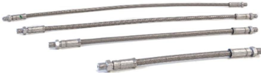
Set de tubos de distribución en cobre DE:3 mm, DI:1 mm, con rosca en un extremo M8x1(M) y acoplamiento a tubo de cobre con anillo de cierre DI:3 mm.
