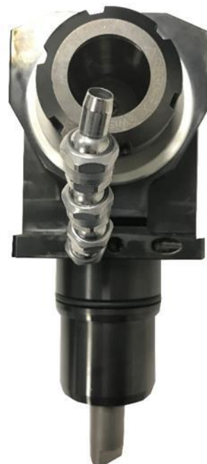
Système HECTO monté dans un porte-outil rotatif. Buse droite DI:6 mm & L:16 mm
