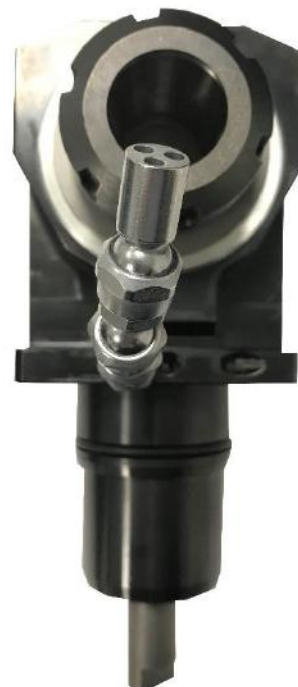
Système HECTO monté dans un porte-outil rotatif. Buse droite Coaxial. DI:3,4 x 3 & L=20 mm
